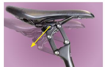
Parallelogrammstützen federn in Stoßrichtung, und sie bieten deutlich mehr Komfort als axial gefederte Stützen
